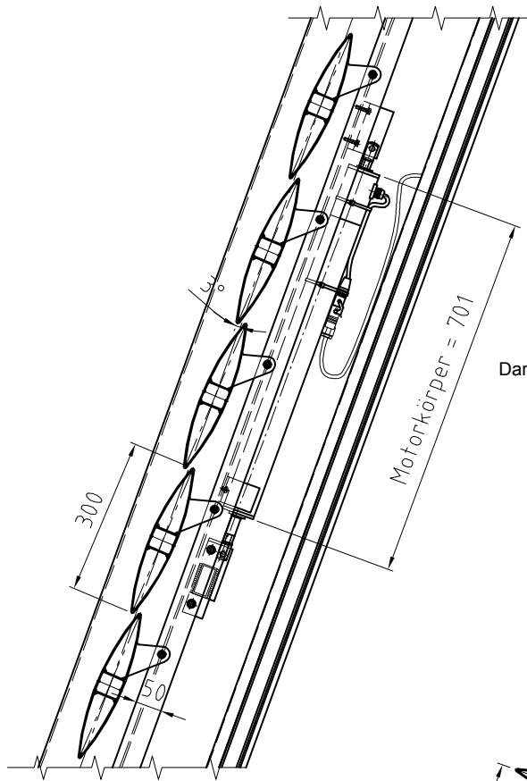
Darstellung: Motor ausgefahren / Lamelle geöffnet
